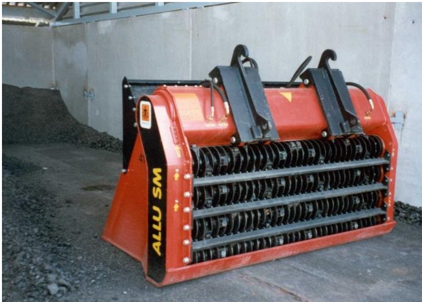
Bilde 6.4 Granuleringsskuffe sett fra undersiden
