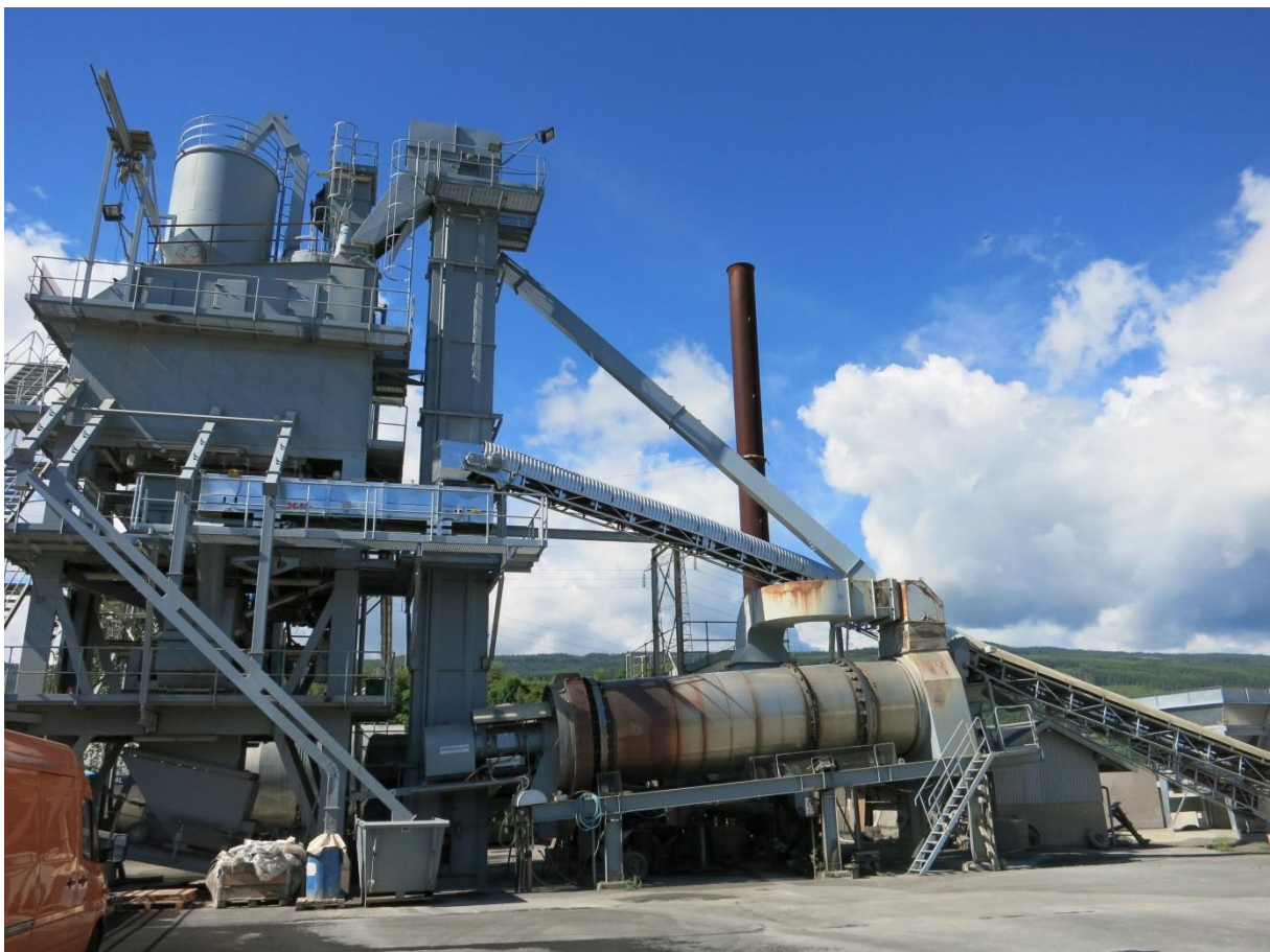
Bilde 9.2 Tilsetning av asfaltgranulat i miksekammeret
