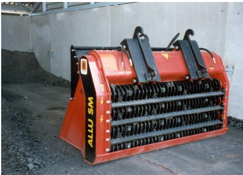
Bilde 6.4 Granuleringskuffe sett fra undersiden
