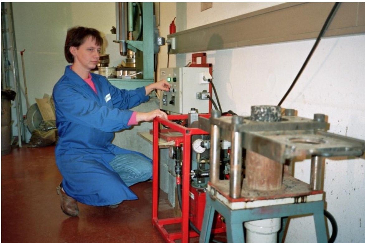
Figur 7.8 Tillaging av prøver med statisk presse
