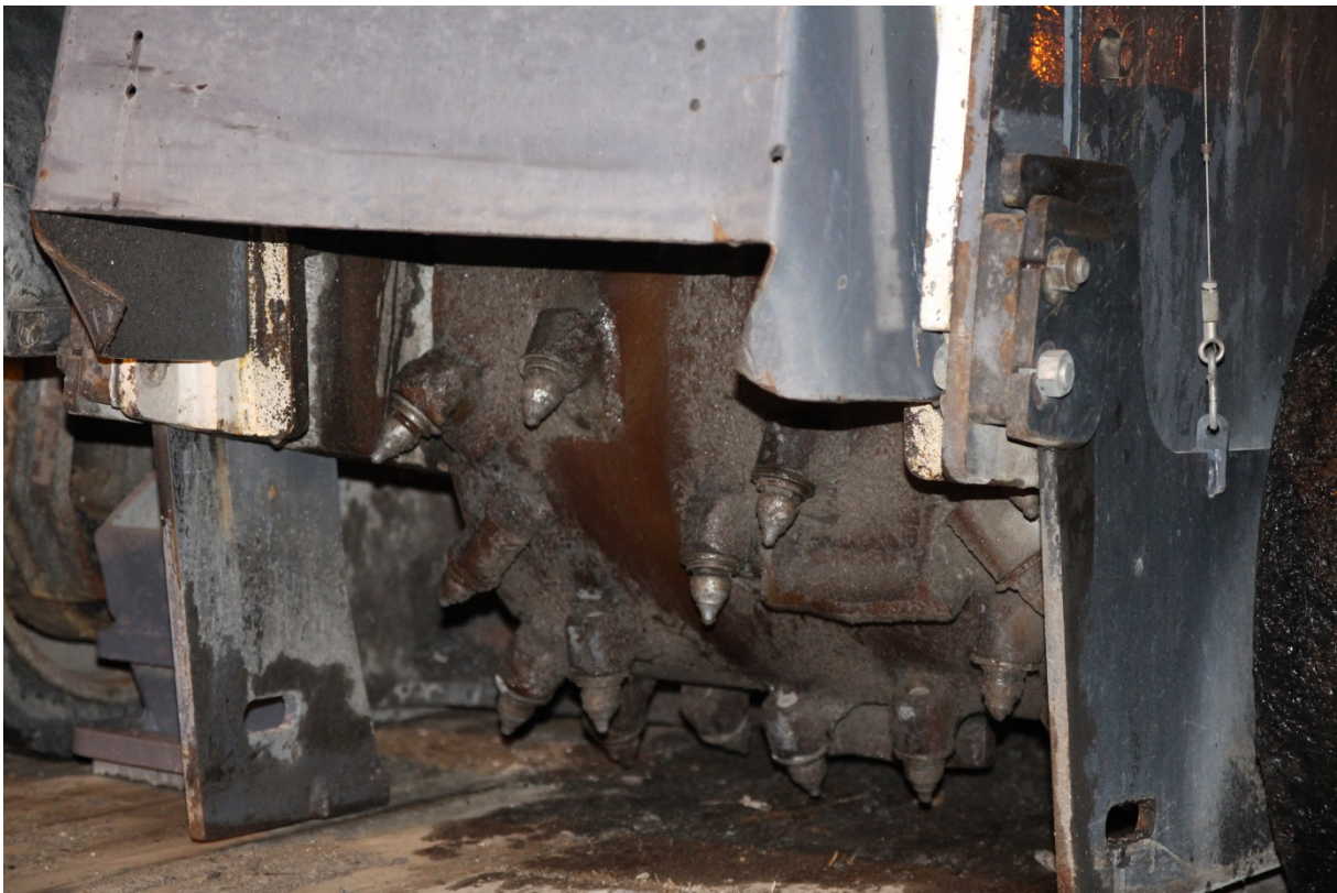
Figur 3.4 Fresetenner på en asfaltfreser (Foto: Karoline Vaager)
