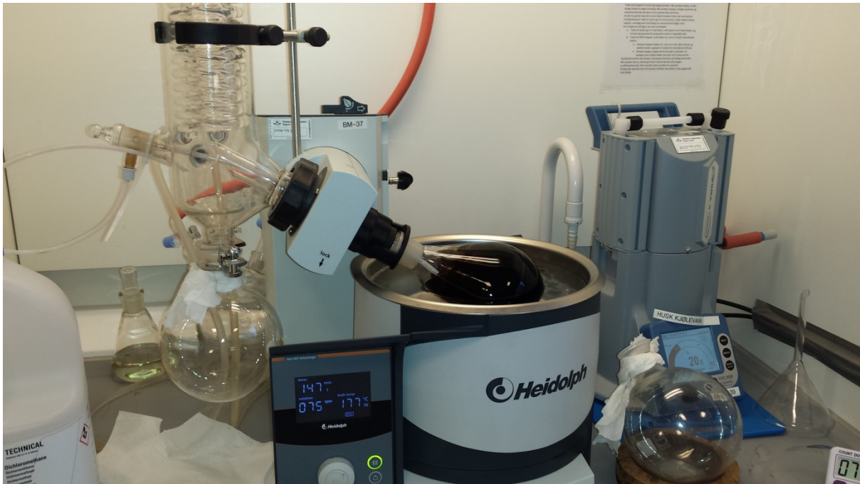
Figur 3.12 Inndamping av metylenklorid fra det ekstraherte bindemiddelet
