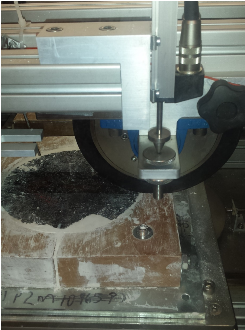
Figur 3.27 Testing av borkjerne fra referansestrekning A i Wheel Track
