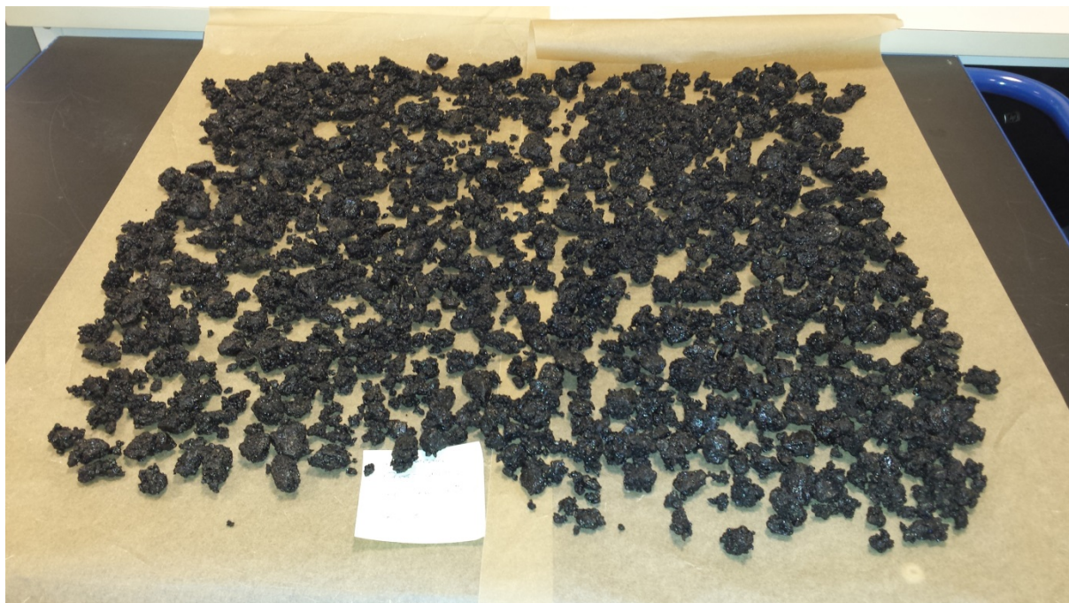
Figur 3.11 Masseprøve A er klargjort for ekstraksjon
