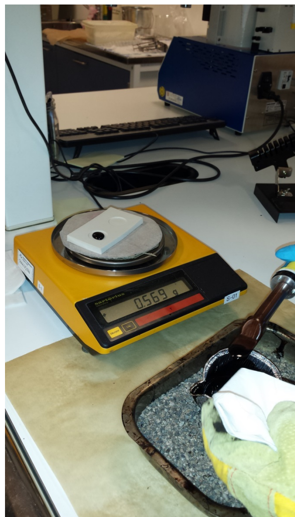
Kalibrering av apparatur og innstøping av bindemiddellinser til MSCR testing
