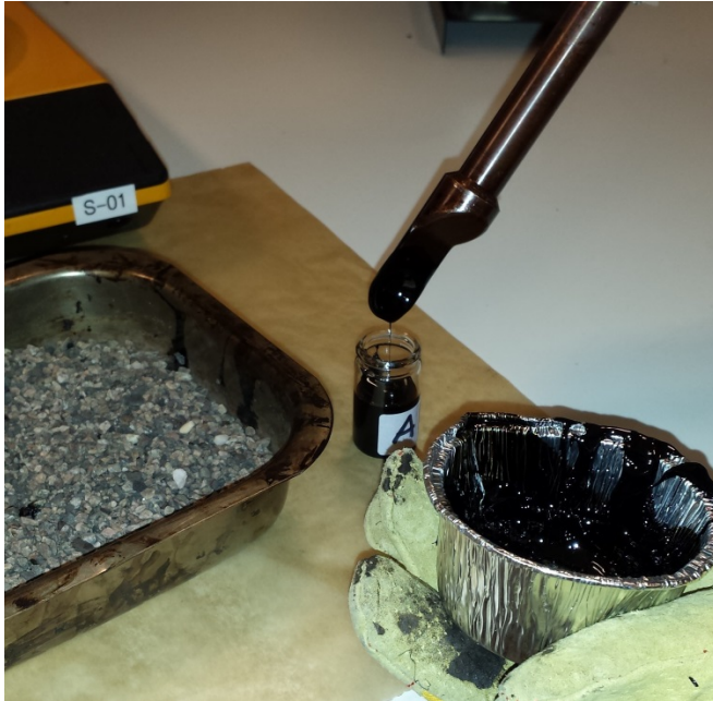
Figurene 3.20 og 3.21 Små prøvebegre med gjenvunnet bitumen ble sendt til Veidekke Industri AS for testing av Fraass bruddpunkt
